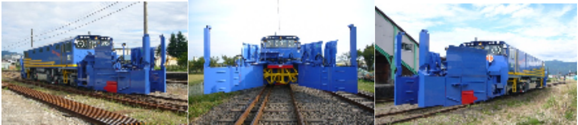
最新鋭の除雪車（１台でロータリーとラッセルの機能を持つ）
